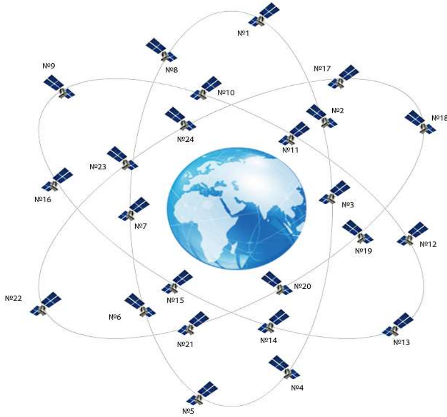
Şekil-3. Glonass Uydu Sistemi/Glonass Satellite System Kaynak: Space News, (2015).
