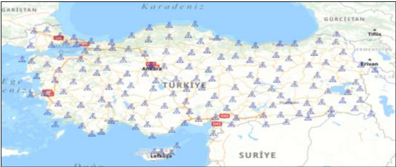
Şekil-9 Türkiye'de kullanılan TUSAGA-AKTİF istasyonları/TUSAGA-ACTIVE stations used in Turkey Kaynak: (TUSAGA-Aktif. (2020, 24 Şubat).
